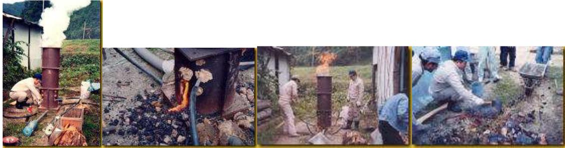
実験に使った製鉄炉 鉄滓が流れ出る
